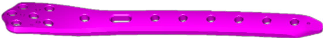
**Figura 4.6 Geometría final de una placa (Placa 7)**
