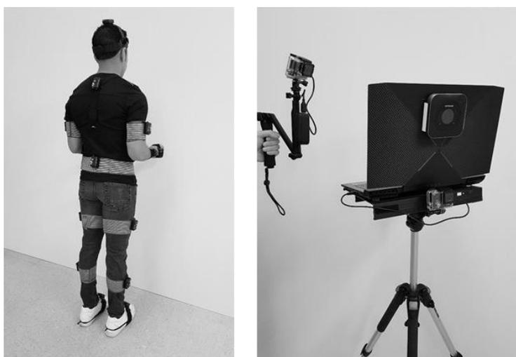
Figura A.6: Instrumentación: sensores inerciales y fijación al cuerpo (izda.) y ordenador y cámaras (dcha.)
