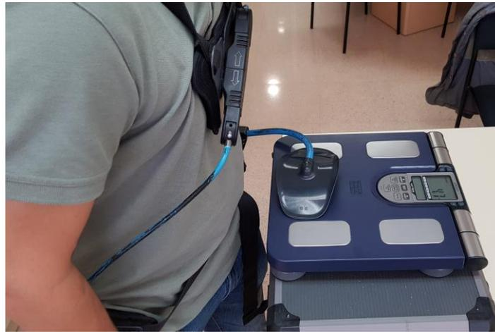
Figura 5: Medición de la fuerza del Laevo para estimación del torque a través de una báscula
