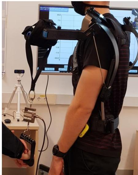
Figura 10: Medición de la fuerza del Skelex a través de una célula de carga anclada al manguito
