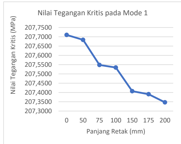
Gambar 7. Tegangan kritis variasi model sekat bergelombang.
