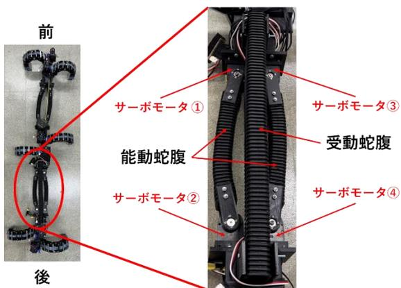
図16 後胴体の機構
