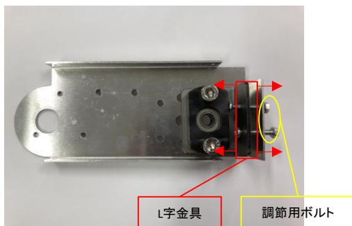
Fig.8 履板たるみ調節機構(機体側面パーツ)
