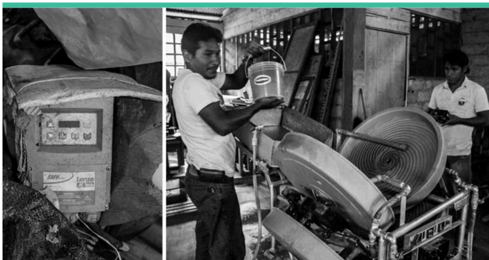
Figura 10: A la izquierda, elementos de una máquina de lixiviación; a la derecha, demostración de la máquina gravimétrica desarrollada por la ONG Caritas Suiza © Wanamei, 2014.
