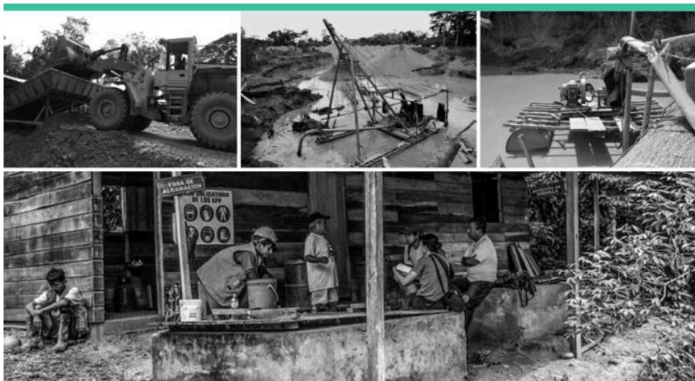
Figura 6: Arriba, los sistemas de extracción utilizados por las 3 comunidades estudiadas: desde la izquierda hasta la derecha: 1. Sistema de Shute cargador, concesión Sol Naciente, Don Braulio; 2. Sistema de Traca, concesión Fortumil; 3. Sistema de chupadera, Boca Inambari. Abajo se muestra entrevistas con los mineros de Fortumil en la zona de trabajo dedicada y siguiendo las normas de gestión ambiental y salud (Photo © Wanamei, 2012).
