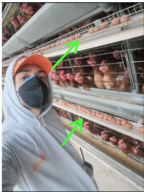
Apéndice DD. Bandas transportadoras de huevos, las flechas señalan dos bandas del nivel 2 y 3 del módulo de producción.
