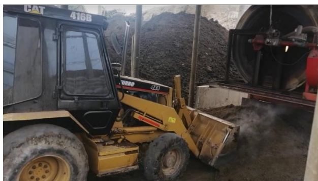
Apéndice BBB. Rotasek secando gallinaza (en la imagen se observa la salida de gallinaza con humedad del 40% y recogida por maquinaria para armar las montañas de gallinaza en el área de compost).
