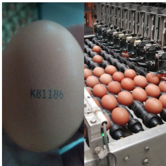
Apéndice PP. Código huevo al lado izquierdo e impresora de código al derecho.
