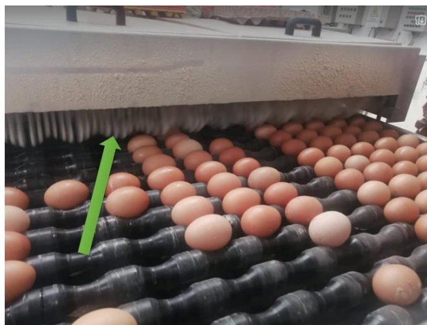
Apéndice OO. Escobilla de limpieza en clasificadora de huevos, en la imagen se observa señalada por la flecha verde las escobillas que van limpiando los huevos mientras son transportados y van rotando al tiempo.
