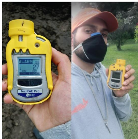
Apéndice HHH. Medición de amoniaco, en la imagen izquierda vemos un nivel de amoniaco que genera alarma, (este nivel se generó manualmente para plasmar en el apéndice cómo sería la señal de alarma del ToxiRAE Pro).
