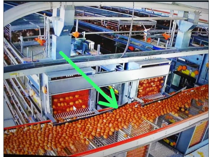
Apéndice MM. Cadenas transportadoras de huevos (aéreas) señaladas con la flecha verde, las que se encuentran dentro de los galpones no están cubiertas por techo ya que en los galpones las aves no llegan.
