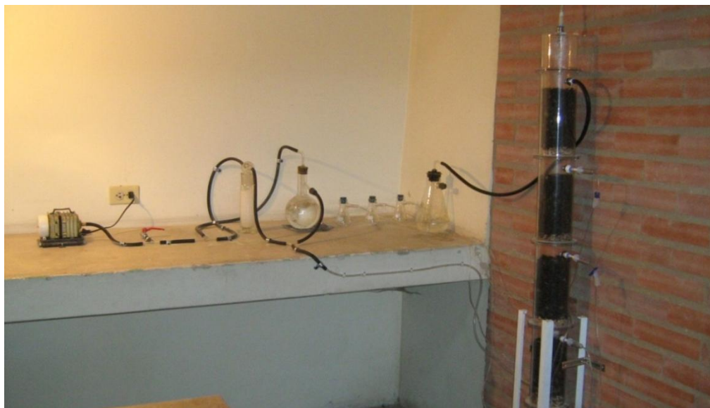
Figura 6. Sistema de Biofiltración de Formaldehido, Montaje Definitivo.
