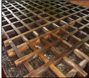
IMAGEN 19 "VERTIMIENTO DE LA COCHADA EN LAS GAVERAS"
