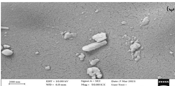
شکل ۱- (الف) میکروگراف FESEM کربن فعال حاصل از: الف) میوه بلوط و ب) بهینه شده با آمونیوم کلرید
