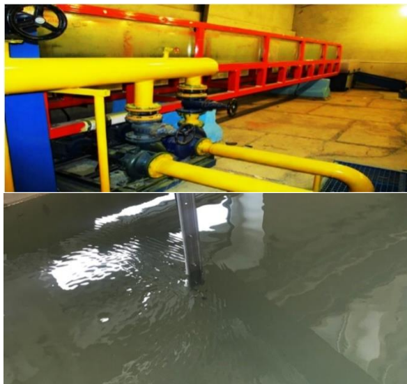
شکل ۱- کانال آزمایشگاهی و موقعیت سرعت‌سنج ADV داخل جریان در حال اندازه‌گیری
