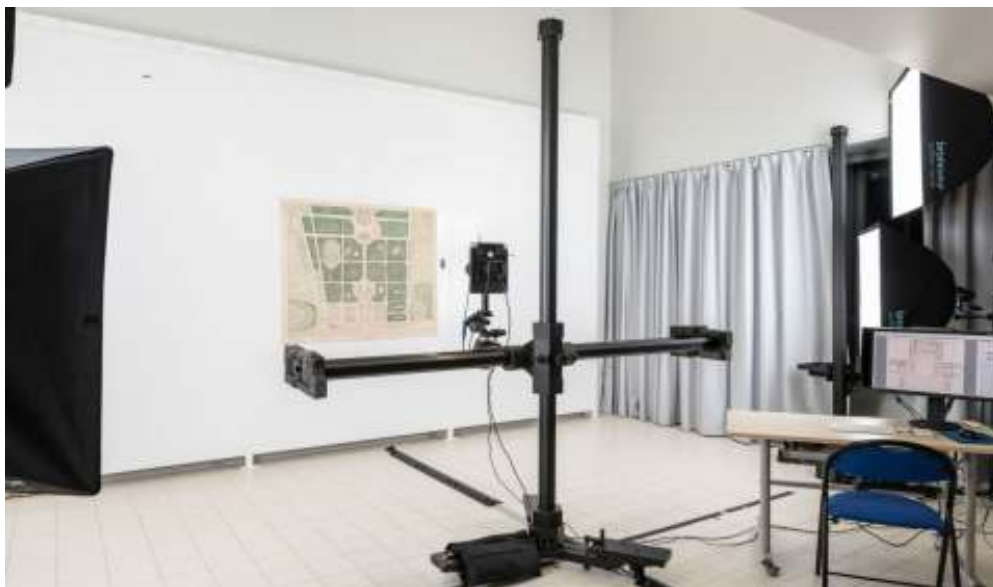
Figure 1. Équipement de numérisation pour les très grands formats
