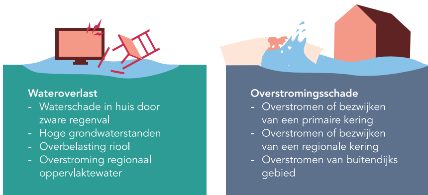
Figuur 6.1 Schade door extreme regenval: wateroverlast en overstromingsschade
