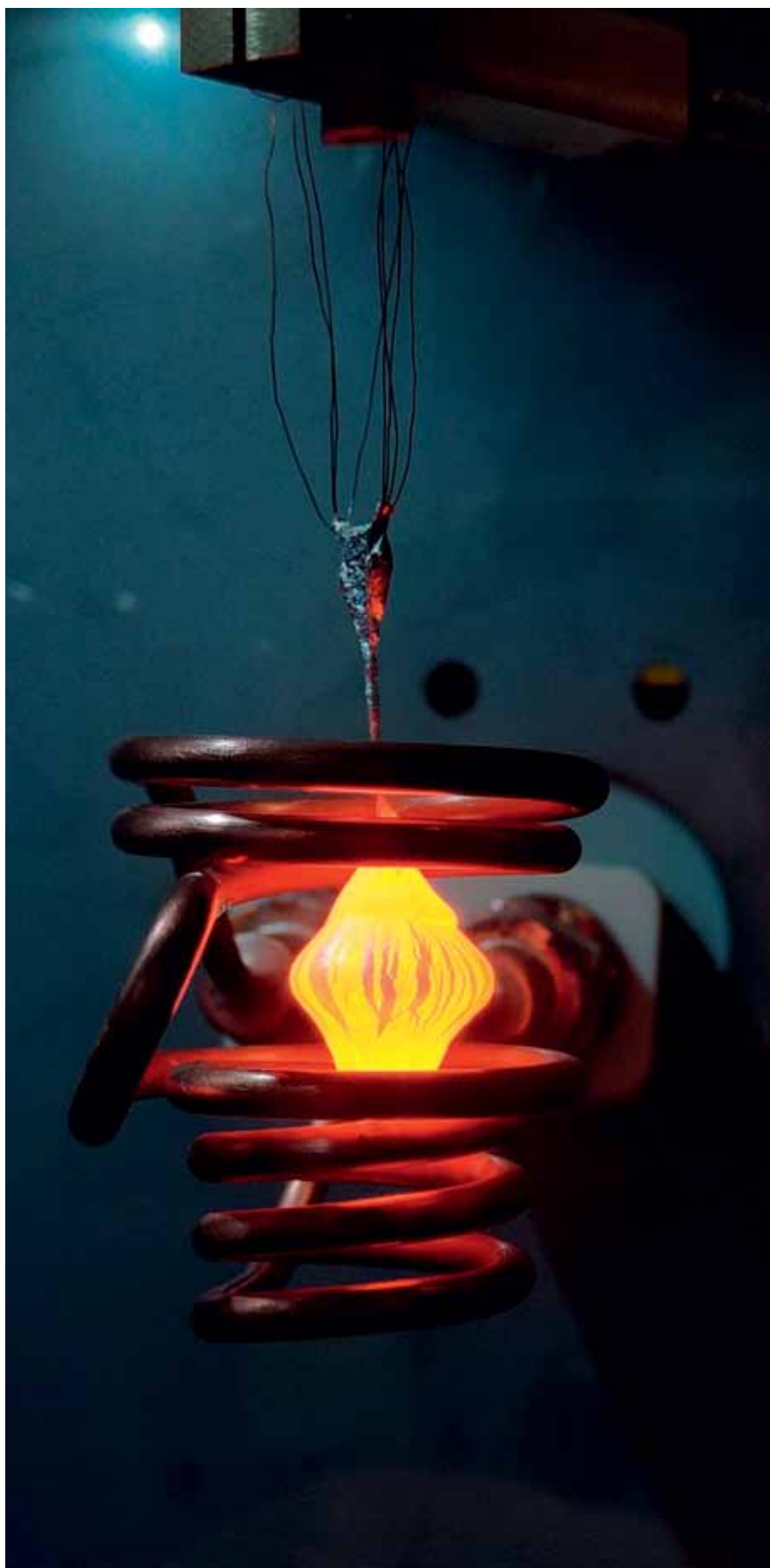
Figuur 4 Elektromagnetische levitatie van gesmolten aluminium in lucht, met een polykristallijne kiem.
