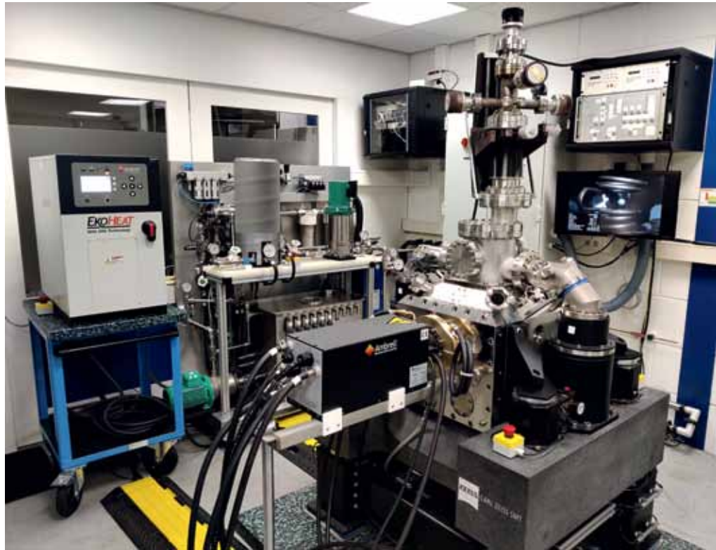
Figuur 3 Foto van de opstelling voor zwevende kristalgroei. In het midden staat de vacuümkamer, op de achtergrond zijn v.l.n.r. zichtbaar: de stroombron, het koelwatersysteem en een monitor die het camerabeeld weergeeft.
