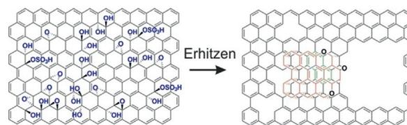
**Schema 1.** Schematische Darstellung der chemischen Struktur von oxo-G und thermisch verarbeitetem oxo-G (angegeben als oxo-G<sup>T</sup>). Letzteres führt zur Bildung von Löchern und halbleitenden Bereichen, die sp<sup>3</sup>-C enthalten.
