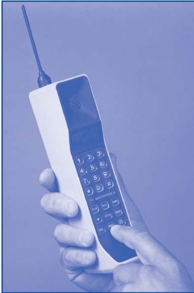
Figuur 9. Functievulling: de Motorola DynaTAC 8000X (1983) was de eerste 'FCC-approved portable cellular telephone' (FCC: Federal Communications Committee). Hij woog bijna 1 kg, had afmetingen van 33x9x4,5 cm en beschikte over een LED-display. Er kon één uur mee worden getelefoneerd en de standby-tijd was acht uur. De kostprijs bedroeg $ 3.995,-.
