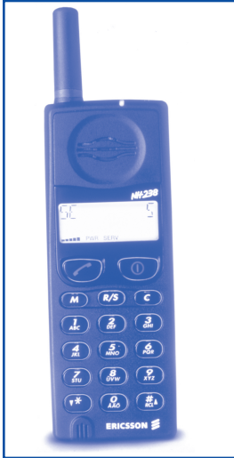
Figuur 10. Detaillering: de Ericsson NH 238 (1995). Tot het begin van de negentiger jaren van de vorige eeuw waren de ontwikkelingen van het mobieltje voornamelijk gericht op productverbetering. De aandacht ging uit naar verhoging van de betrouwbaarheid, verlaging van het gewicht, verkleining van de afmetingen en uitbreiding van de infrastructuur.
