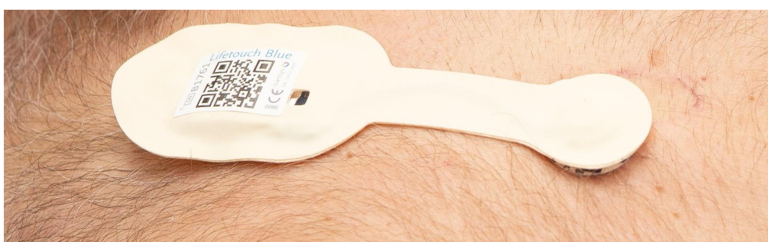
FIGUUR 1 Isansys LifeTouch sensor voor draadloze metingen van hart- en ademfrequentie
