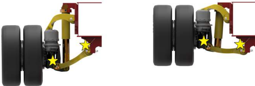
(a) Verplaatsing van het draaipunt van de dwarsstang.
