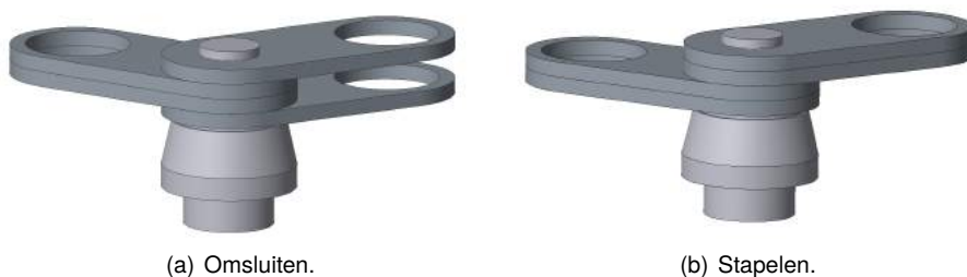
Figuur 30: Mogelijkheden lagering centraal scharnierpunt.
