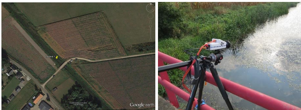
Afbeelding 3. Meetlocatie (links) en Cubert full-spectrumcamera (rechts) als sensor voor waterplanten. Opnames bij de Lage Raam, 15 september 2016 (foto: Gé van den Eertwegh)
