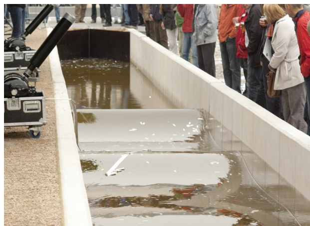
Figuur 2 a) Na het openen van de sluisdeur vormt zich een hoofdsoliton met twee lagere nevgolven die zich alle coherent en met fasesnelheid c door de goot voortplanten. b) De getekende sech 2 -soliton \eta(x, t) op basis van (1.2) lijkt op de experimenteel waargenomen hoofdsoliton.
