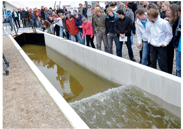
Figuur 3 a) Schets van het model voor een (lopende) hydraulische sprong en b) foto van de sprong in het soliton-splash-spektakel. Foto: Universiteit Twente.
