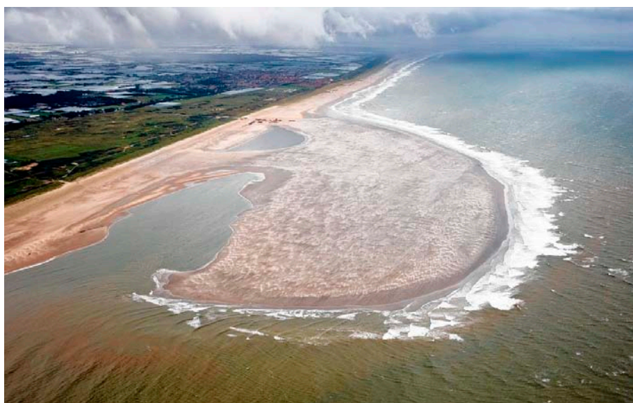
De Zandmotor tussen Hoek van Holland en Scheveningen is een bekend voorbeeld in Nederland van Bouwen met de Natuur voor waterveiligheid, recreatie en natuur.
