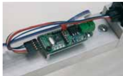
Figuur 6. Print op de knie. Deze print leest de encoder in, bestuurt de knievergrendeling en is verbonden met de TWI-bus door de vier gekleurde draden.
