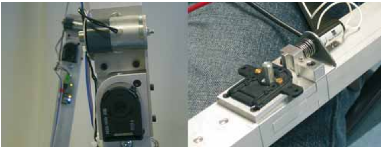
Figuur 5. Het huidige mechaniek met de magneten (links) en het oude mechaniek met de vergrendelingspin.
