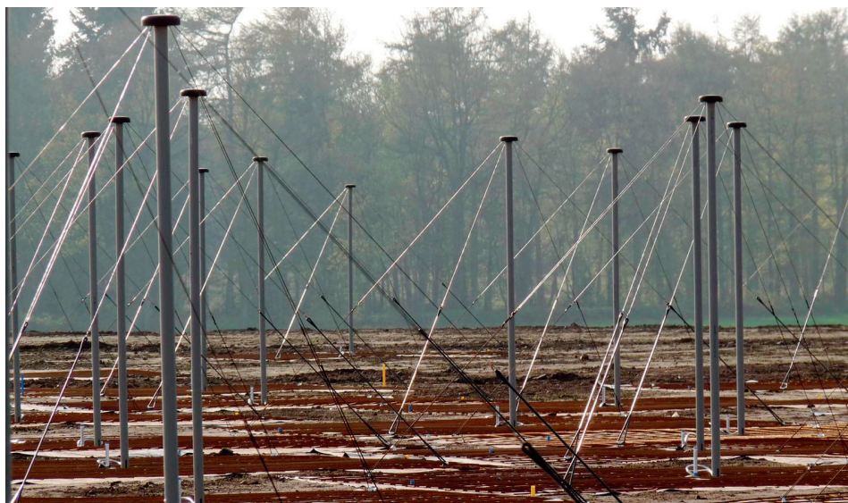
Fig. 4 De Low Band Antennes van LOFAR. De LBA bestaat uit een (PVC) buis die afgespannen wordt door draden die de antenne vormen. In de kop van de LBA bevindt zich de Low Noise Amplifier. De signalen worden via coaxkabels naar de ontvanger in de centrale kast op het station getransporteerd.
