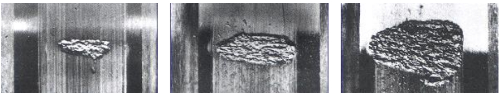
(d) Surface-initiated fatigue, Neale (1973).
