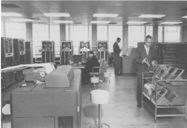
De IBM 705 van de KLM in bedrijf. De enorme hoeveelheid vervoersgegevens die enkele jaren bewaard moesten blijven, werd opgeslagen op magnetische banden. Dit leverde een enorme ruimte- en kostenbesparing op vergeleken met de twintig miljoen ponskaarten die bij de mechanische administratie werden bewaard.
