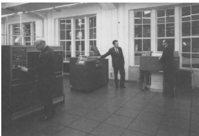
Medewerkers van de Postcheque- en Girodienst bij de IBM 1401 in 1962. De machine in het midden is de ponskaartenlezer voor de invoer, links staat de centrale verwerkingseenheid met het bedieningspaneel en rechts een printer.
