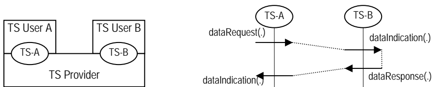
Figuur 2: Transport service: (a) service structuur; (b) service gedrag.
