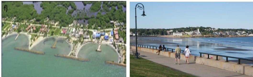
Gambar 5. Contoh detached breakwater yang dipergunakan untuk melindungi pantai di kawasan wisata (Kanan), contoh jalur pejalan kaki di sepanjang pantai yang dikombinasikan dengan sistem pertahanan pantai di Coastal Marblehead, Massachussetts, Amerika Serikat. Satu dari berbagai cara memanfaatkan sumberdaya pesisir (Kiri).
