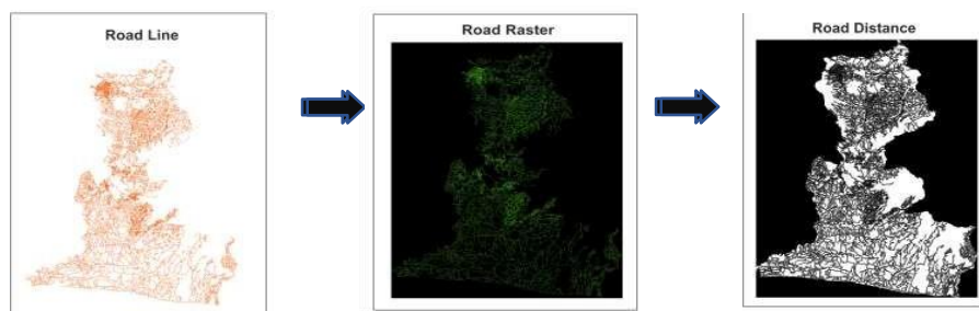
Gambar 2. Proses Pembuatan Jalan berjenis file Raster
