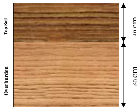
Gambar 3. Rencana Tebal Penimbunan Tanah
