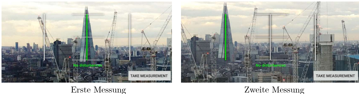
Abbildung 4.18: Phase 3 des Tests: Messung. Links ist die erste Messung mit der Markierung in der Mitte zu sehen, rechts die zweite Messung mit der Markierung auf der linken Seite.
