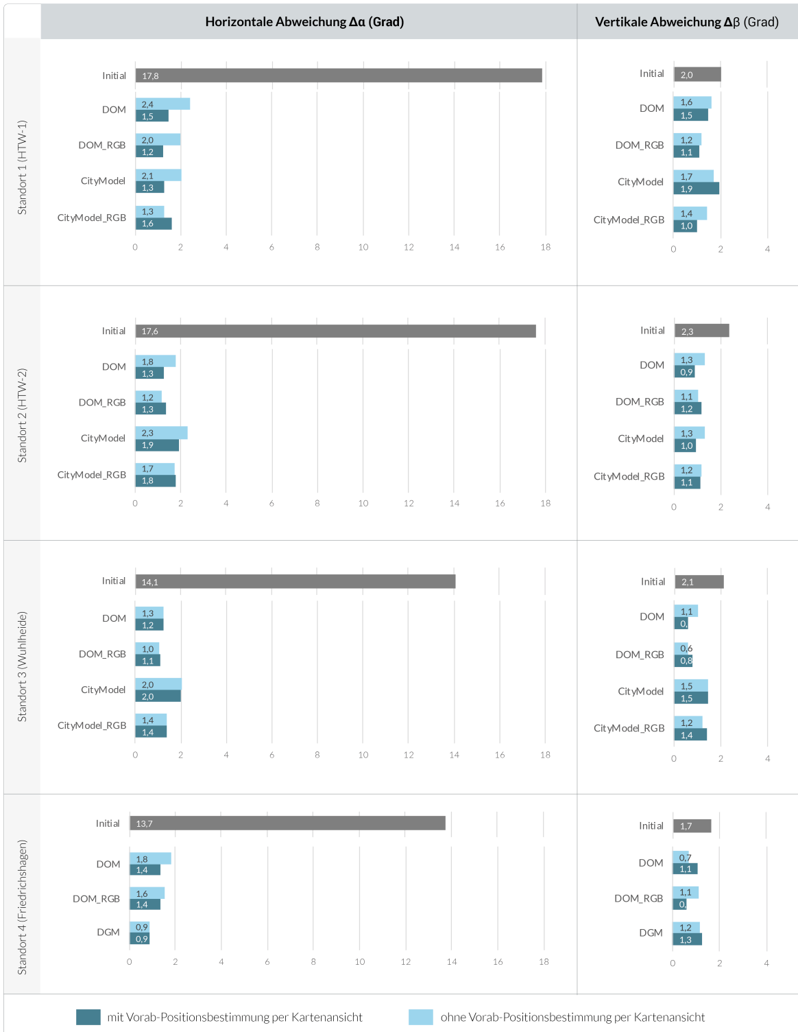
Abbildung 5.11 Gemessene durchschnittliche horizontale und vertikale Abweichung der kalibrierten globalen Geräterotation.
