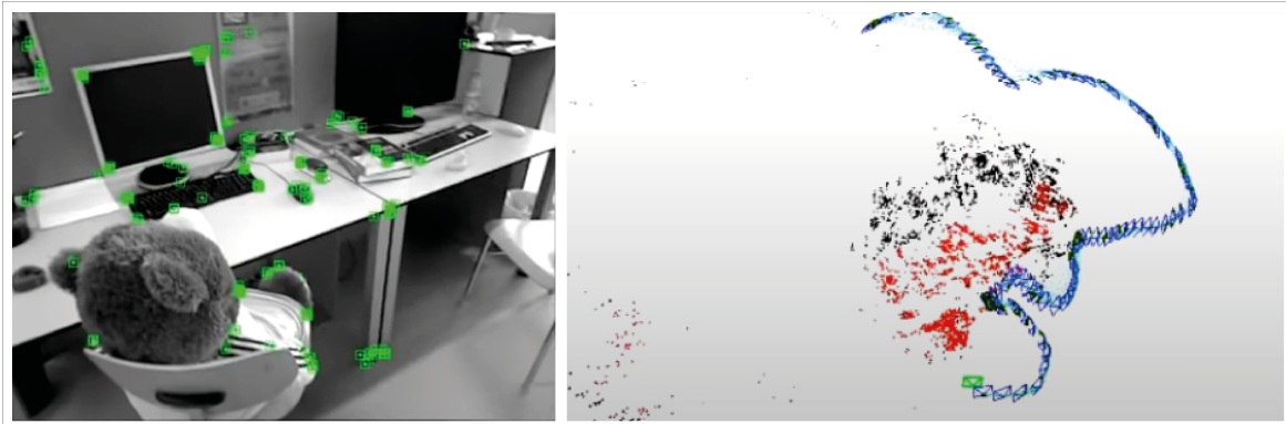
Abbildung 3.3 Registrierung in unbekannter Umgebung mittels monokularer SLAM-Technologie, z.B. ORB-SLAM [102]. In den Kamerabildern werden markante Feature-Punkte der Umgebung erfasst (links; grüne Punkte) und in einer 3D-Punktwolken-Karte gespeichert (rechts; rote Punkte). Mit zunehmender Kamerabewegung kann die Karte erweitert und die Kamerapositionen innerhalb dieser Karte fortlaufend erfasst werden (rechts; blauer Pfad).
