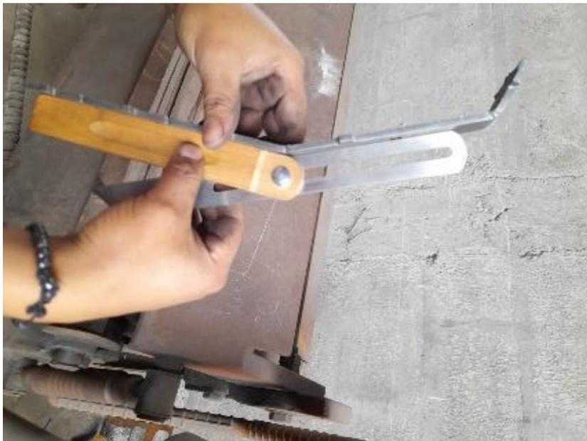
**Figura 3.12** Doblado de Chapa Metálica con uso de graduador y escuadra falsa
