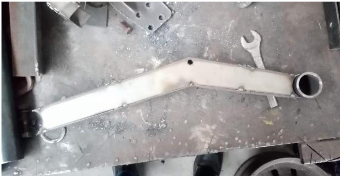
**Figura 3.13** Ensamble brazo de suspensión con puntos de suelda MIG
