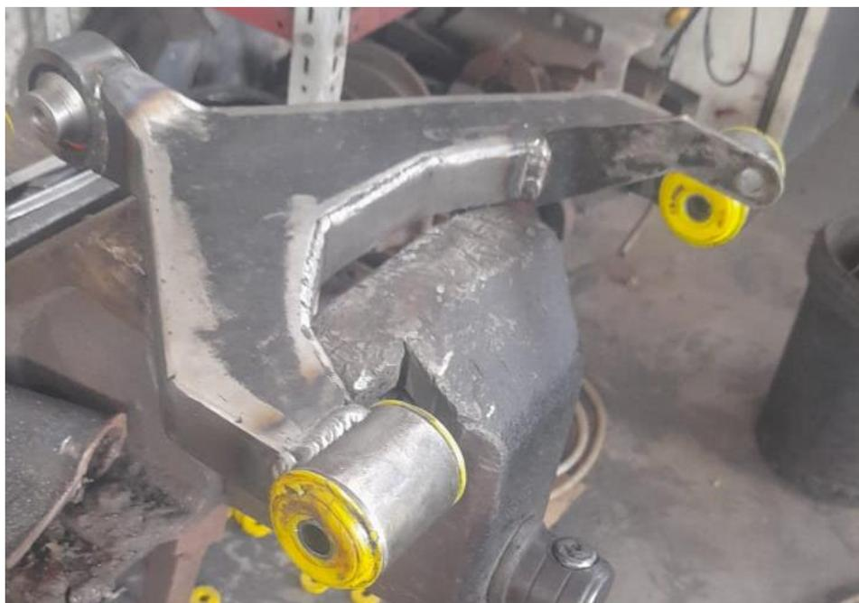
**Figura 3.14** Mesa de suspensión con Silentblock instalados
