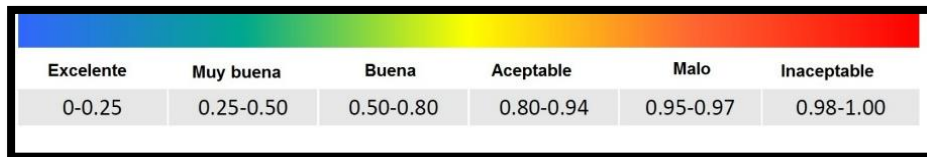
Figura 3.36 Espectro de métricas de malla: Oblicuidad (ANSYS. Inc., 2011)
