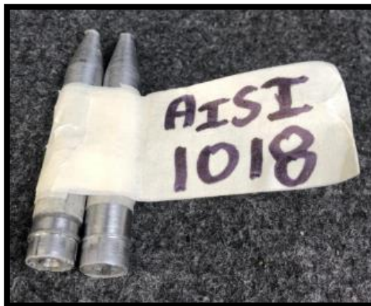
Figura V.2 Probeta de acero AISI 1018 rota con una fuerza radial de 196N
