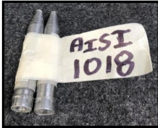
Figura V.1 Probeta de acero AISI 1018 rota con una fuerza radial de 490N
