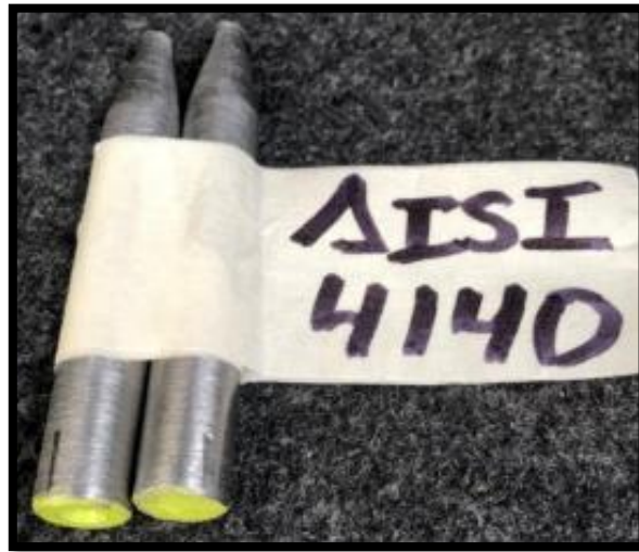
Figura V.4 Probeta de acero AISI 4140 rota con una fuerza radial de 392N
