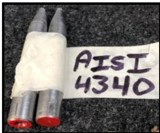
Figura V.3 Probeta de acero AISI 4340 rota con una fuerza radial de 490N
