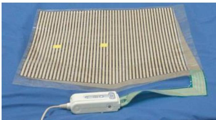
図 2-9 面圧分布測定センサー (BIG-MAT 2000, Nitta) の外観
