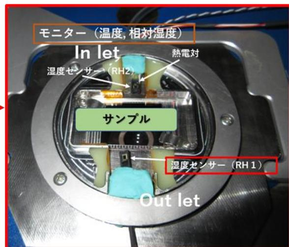
図3-11 サンプルホルダー周囲の機構
