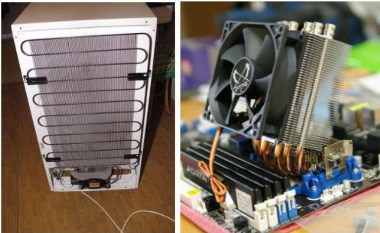
Gambar 9.3. Rangkaian penukar panas pada kulkas (kiri) dan mother board komputer (kanan) (Bolaji, 2020).
