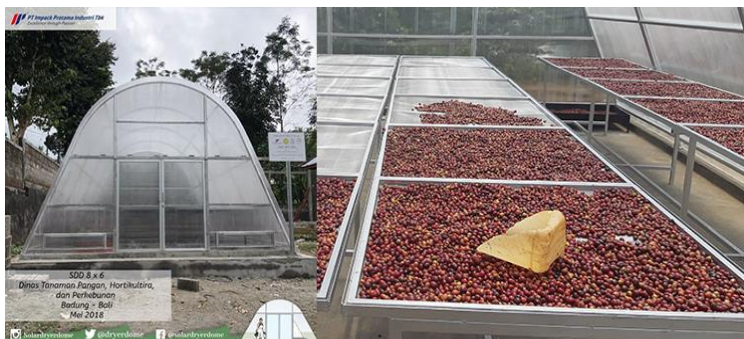
Gambar 13.1. Solar dryer dome pada proses pengeringan biji kopi
