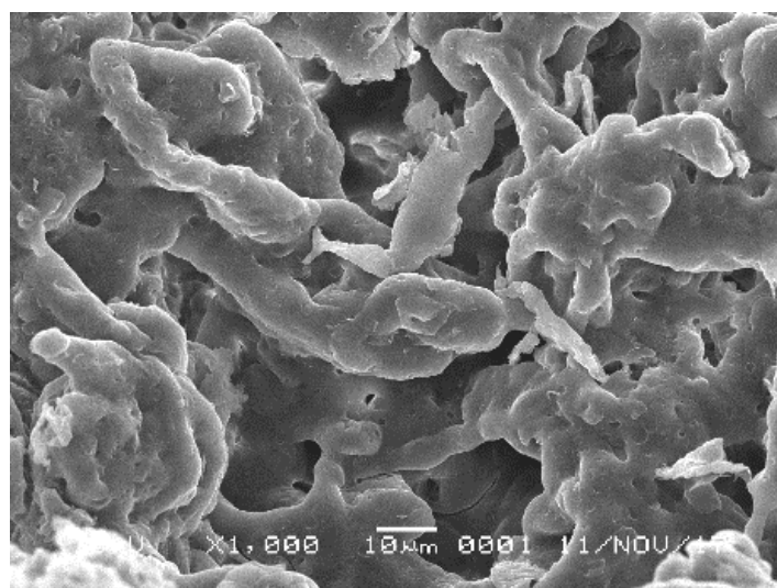
Gambar 2. Hasil SEM mikrokapsul tanpa zat aktif
