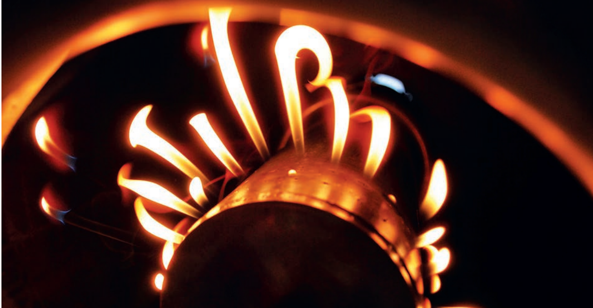
Brennendes Syngas von menschlichem Fäkalmaterial.
