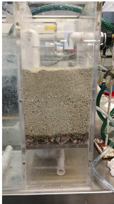
Figura 8.6. Esquema del TSFAH y fotografía del filtro de clinoptilolita con falso fondo en el último compartimiento del TSFAH
