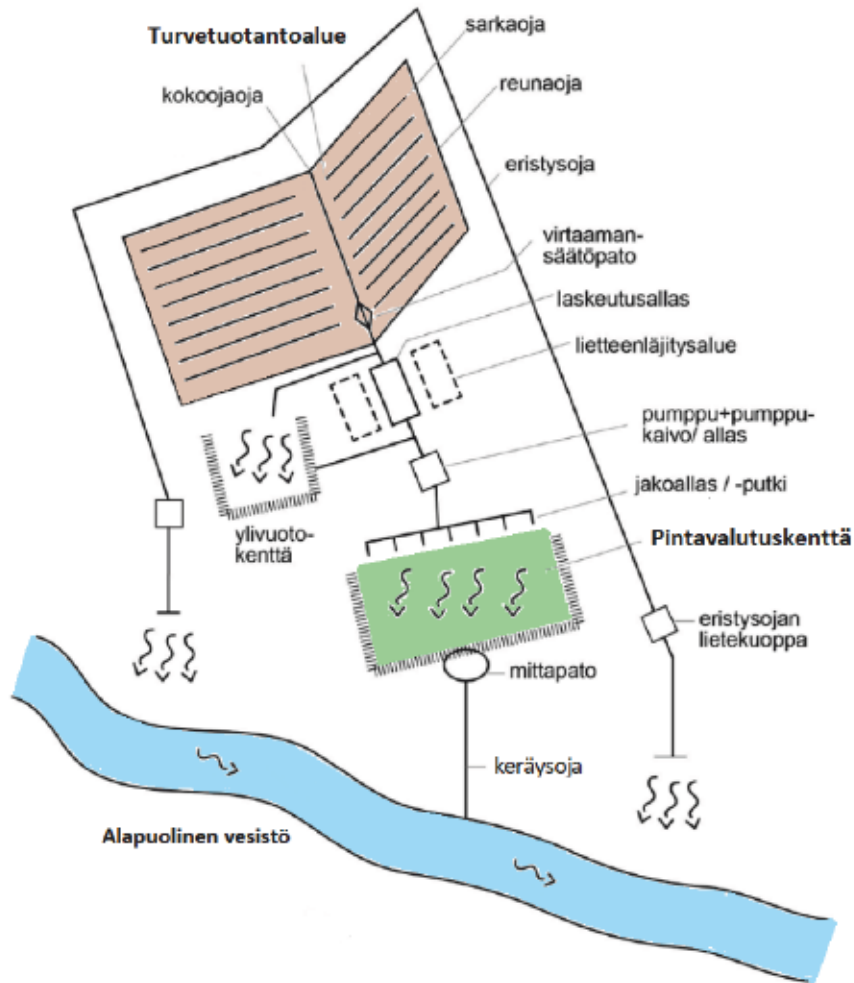
Kuva 1. Turvetuotannon vesienkäsittelyrakenteet. Muokaten Ympäristöministeriö 2015.
