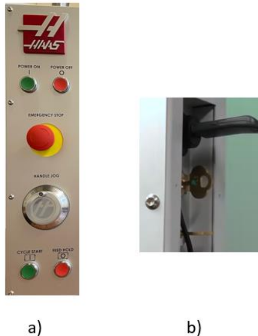
Figura 5.2 - a) Conjunto de botões de controlo manual no lado esquerdo da NGC; b) Conjunto de controlos no lado direito do painel
