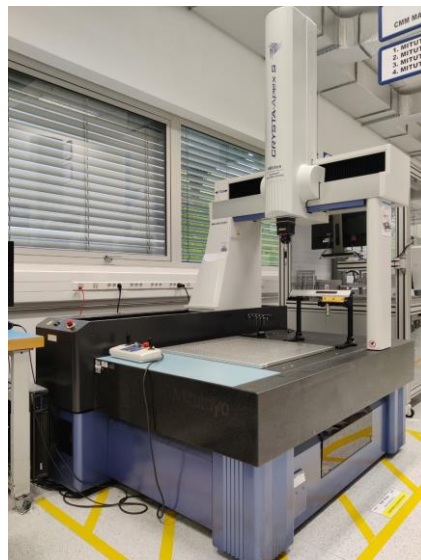
Figura 34 -Foto do equipamento MITUTOYO - CRYSTA APEX S 700 – CMM2.
