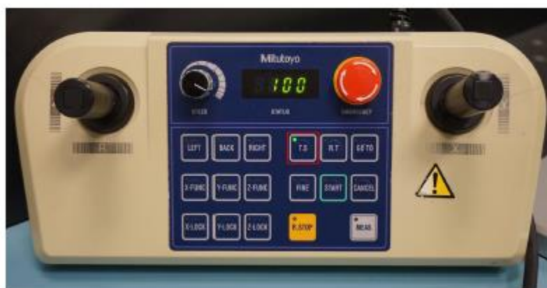
Figura 9 – Ativação do botão T_S do Joystick box.
