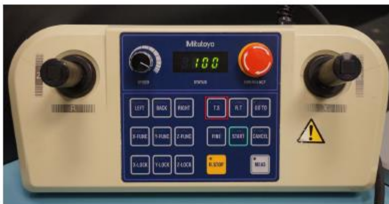
Figura 10 - Desativação do botão TS do Joystick box.
