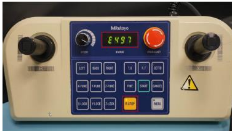
Figura 7 – Erro 497 apresentado no ecrã do Joystick box .
