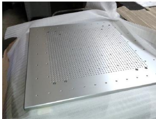
Figura 38 - Base de alumínio das máquinas de medição por coordenadas.
