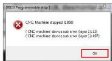
Figura 8 - Erro apresentado no software MCOSMOS quando pressionado o botão R_STOP do joystick box. 9. Clicar em OK na janela aberta no software ( [0323 Programmable stop] ), o erro 497 desaparecerá do joystick box e irá acender-se o led verde T_S (Figura 9).
