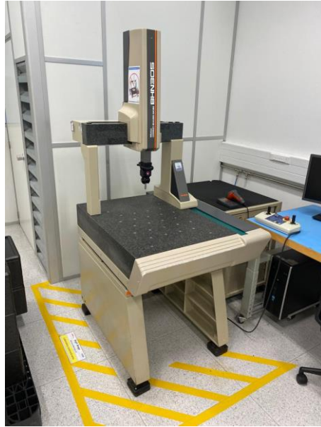
Figura 33 – Foto do equipamento MITUTOYO – BHN - CMM1.
