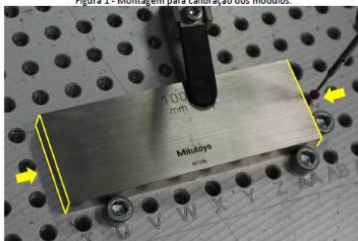
Figura 2 - Superfícies retificadas do bloco padrão.
