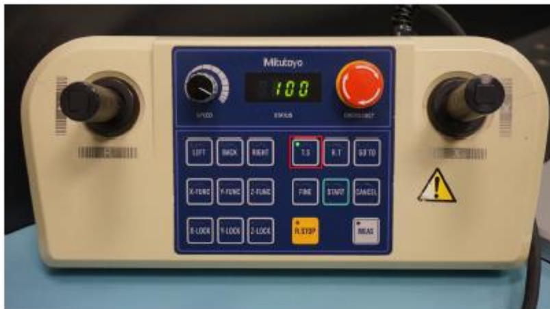
Figura 14 - Ativação do botão T.S do joystick box.
