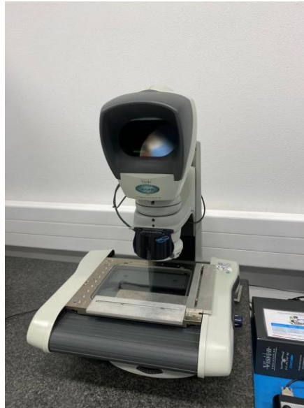
Figura 40 – Foto do equipamento VISION ENGINEERING - HAWK QC-5000 VED.
