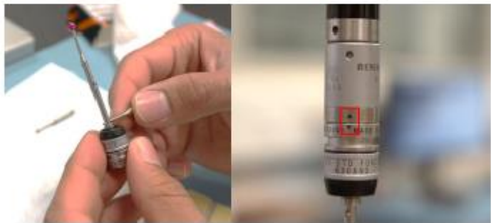
Figura 13 – (a) ferramenta adequada para dar o aperto final da ponteira no módulo. (b) Alinhamento das figuras geométricas da haste e do módulo.
