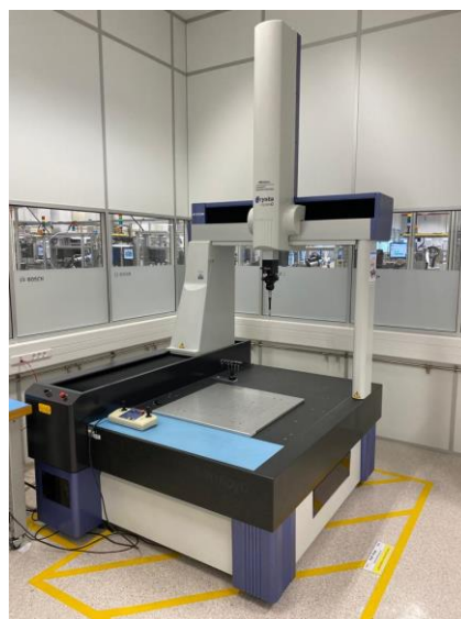
Figura 36 – Foto do equipamento MITUTOYO - CRYSTA APEX C 900 – CMM4.
