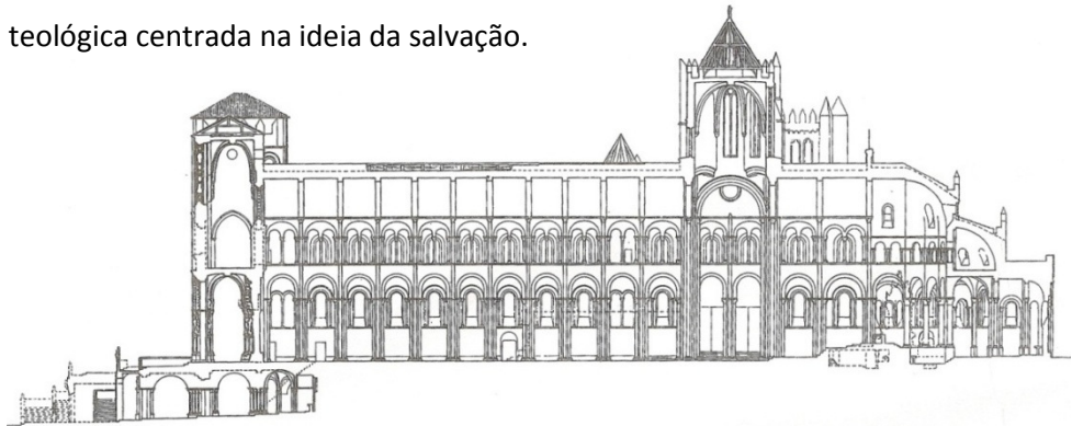
Figura 29 Conant, secção longitudinal da Catedral Românica, à esquerda a cripta e a escadaria que permitem levantar o adro da Catedral até à cota das praças para onde se abre o cruzeiro, a 260m.
