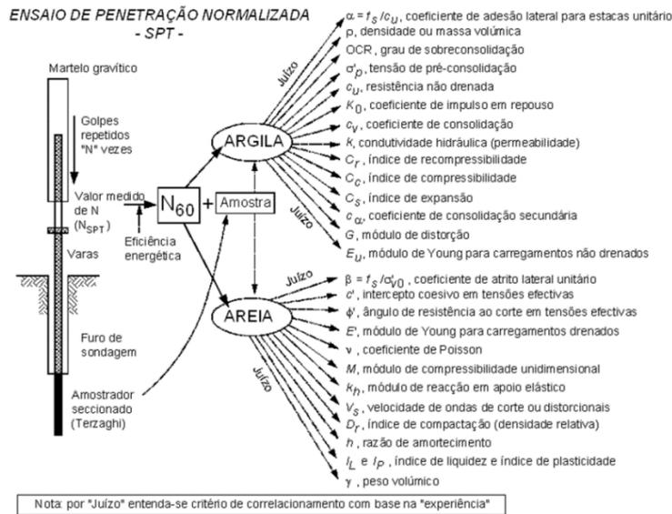
Fig. 1.7 Inferição de múltiplos parâmetros geotécnicos a partir do N\_SPT
