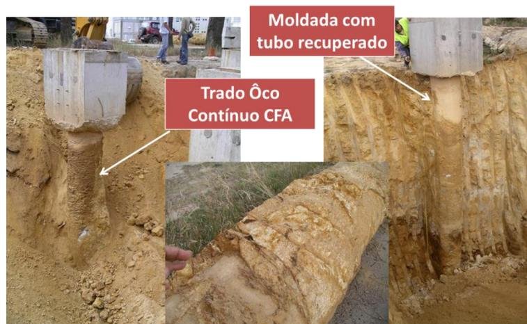
Fig. 7.29 Solo residual em torno de estaca escavada (CFA ou tub. rec.)
