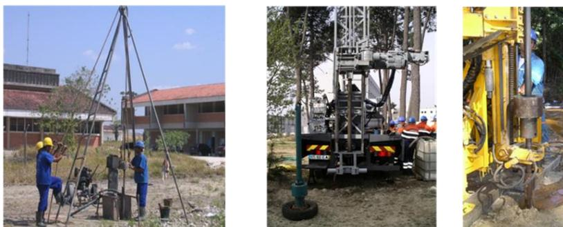
Fig. 1.6 Ilustração de dois equipamentos SPT de gerações distintas em funcionamento
