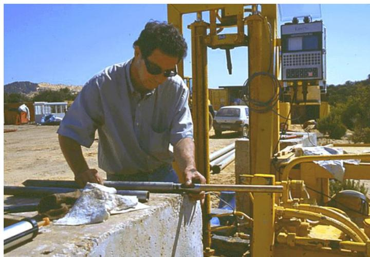
**Fig. 1.14** CPT com equipamento de perfuração
