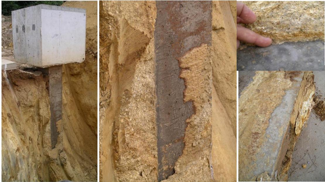
Fig. 7.28 Solo residual em torno de uma estaca pré-fabricada cravada
