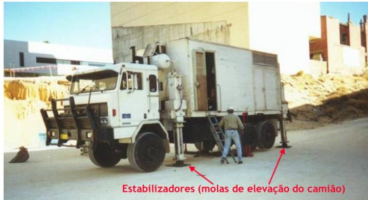
**Fig. 1.12** Unidade CPT (Perth) – Camião de 20 toneladas: reação através do peso
