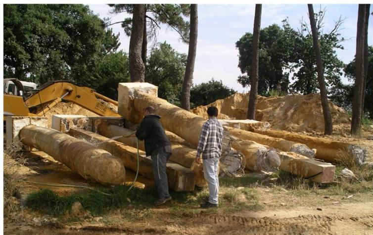
Fig. 7.30 Estacas Moldadas e Cravadas em Solo Residual após Extração – CEFEUP
