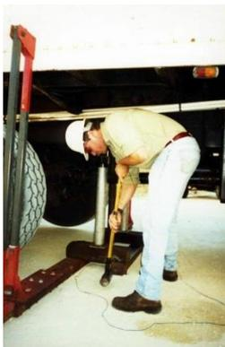
Viga e Martelo de Fonte de onda Distorcional
