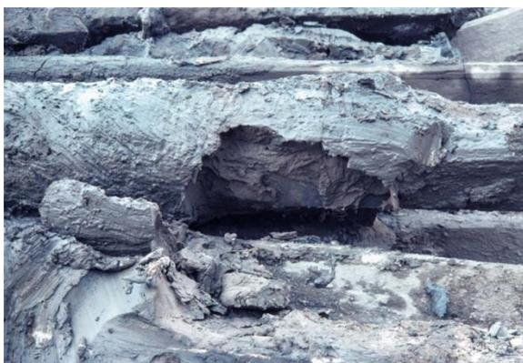
Fig. 7.26 Argila em adesão a uma estaca extraída
