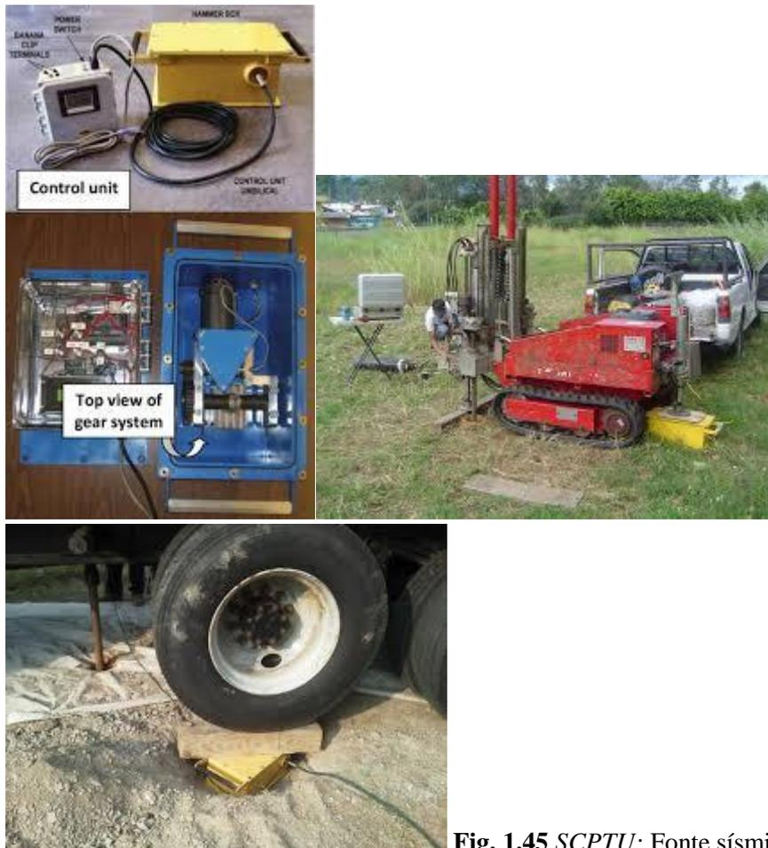
**Fig. 1.45** SCPTU: Fonte sísmica automática
