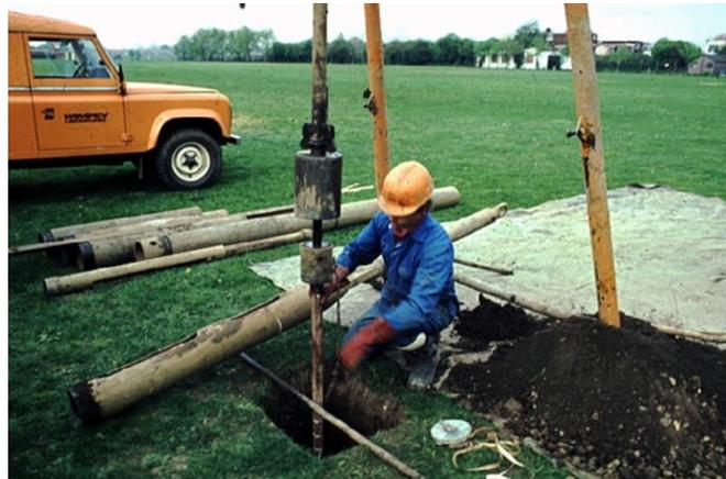
Fig. 7.8 Ensaio SPT com um equipamento clássico (tripé)
