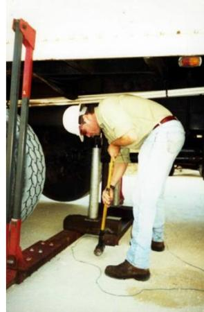
Fig. 4.4 Ensaio CPT sísmico no edifício Woodside em Perth, Austrália
