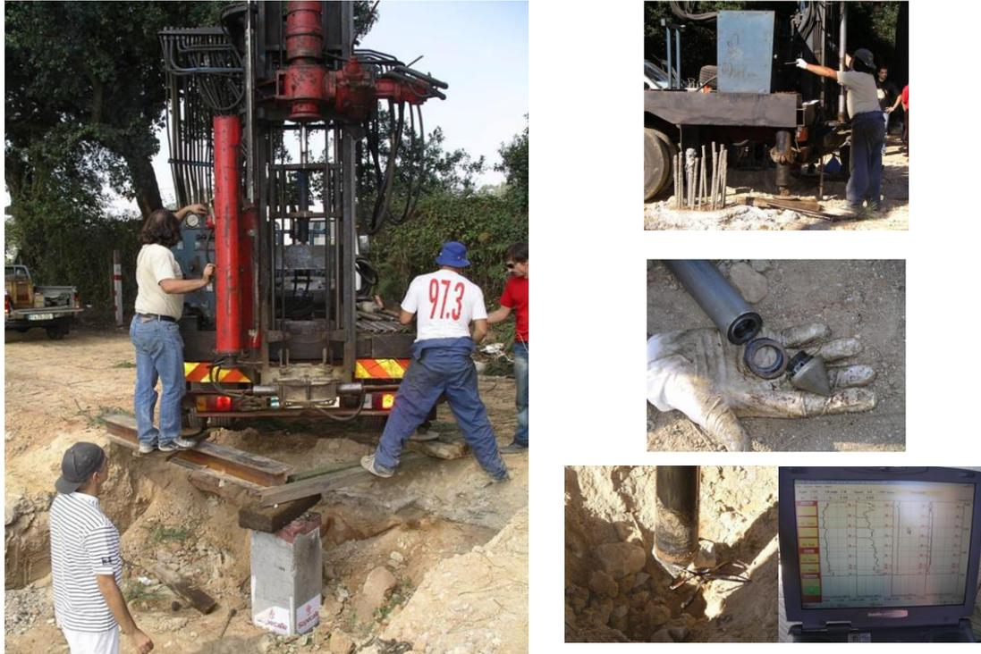
Fig. 1.15 CPT usado com um equipamento de pré-furação (CEFEUP/ISC2)
