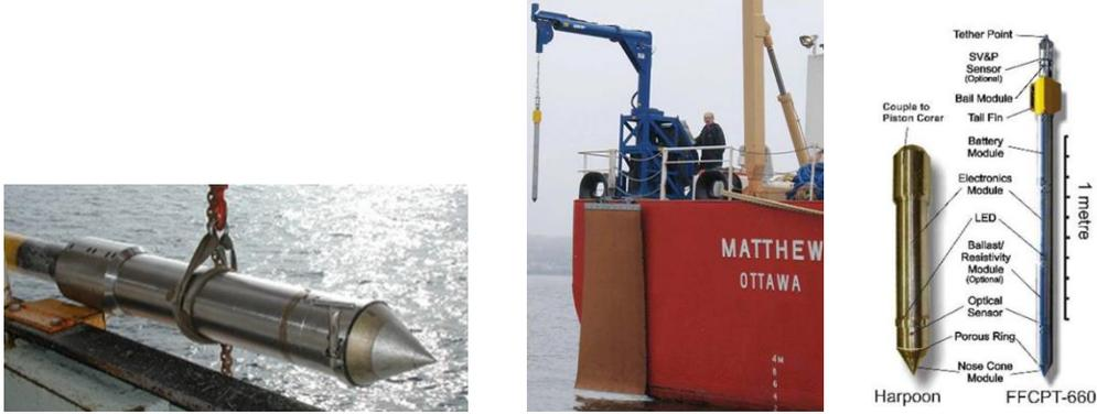
Fig. 1.62 Cone Penetrómetros do tipo “Arpão”
