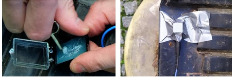
Fig.4 | Montagem do acelerómetro do pé.
