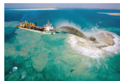
a terraformação, grandes navios transportam no seu cargo toneladas de areia que são expelidas, numa técnica chamada "rainbowing"
