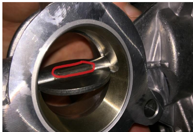
Figura 26 - Exemplo de uma peça NC por soldadura no local errado
