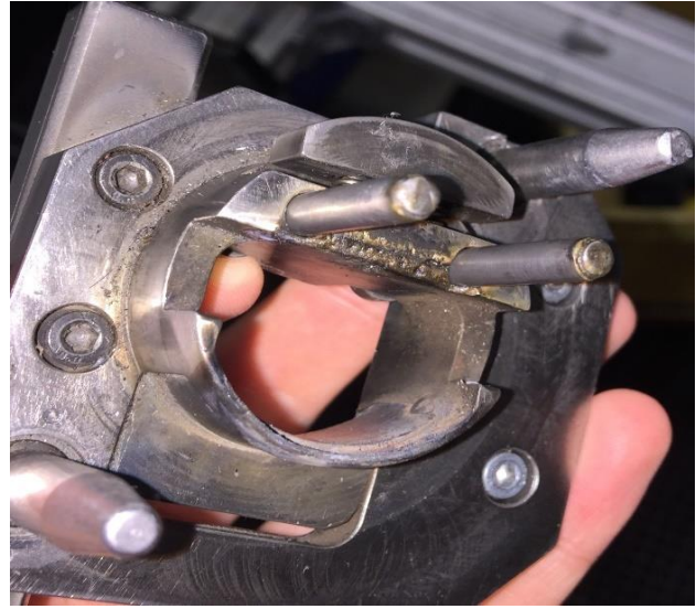
Figura 33 – Fotografia da ferramenta de fixação danificada
