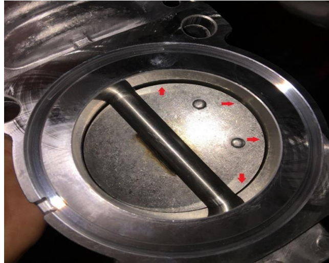
Figura 24 - Exemplo de uma peça NC por apresentar flap descentrada
