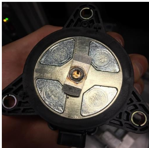
Figura 30 - Resultado do processo de soldadura do driving collar ao solenoide
