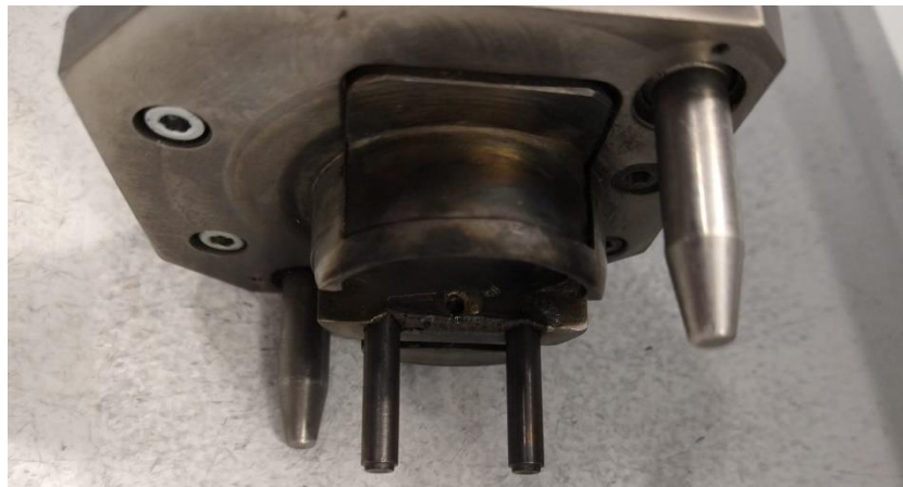
Figura 35 - Fotografia da ferramenta de fixação com pinos novos
