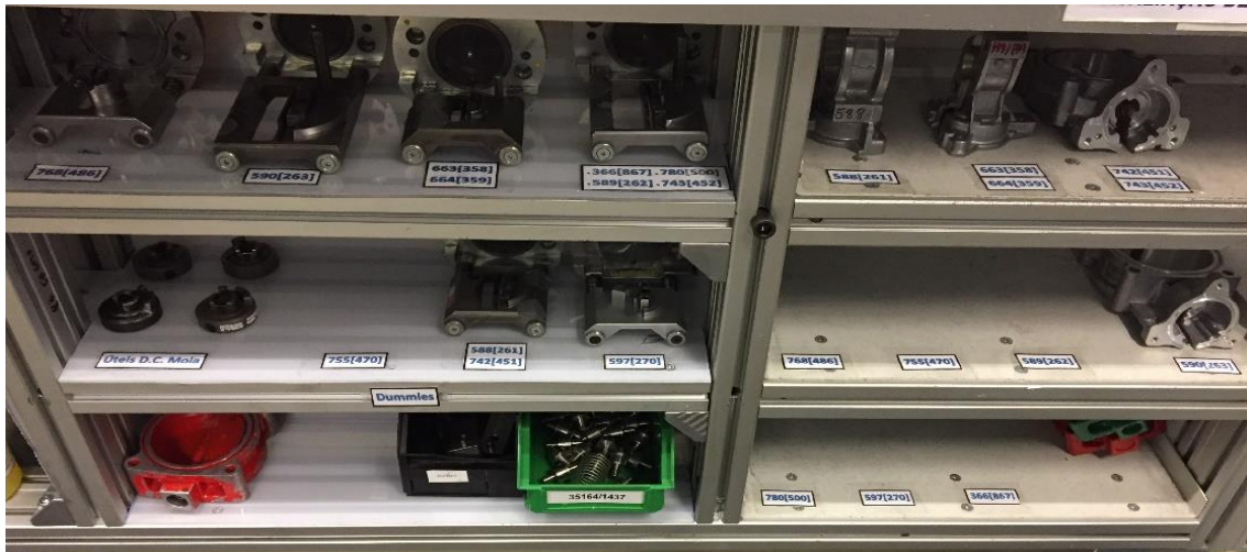
Figura 47 - Fotografia das ferramentas de soldadura da flap devidamente organizadas e identificadas
