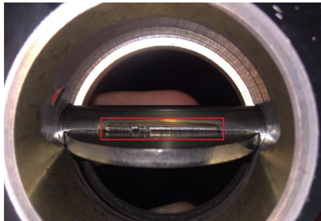
Figura 25 - Exemplo de uma peça NC por má soldadura
