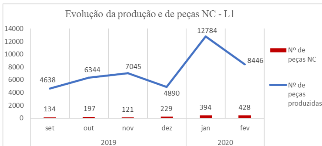
Figura 16 - Evolução do número de peças produzidas e peças NC da linha L1
