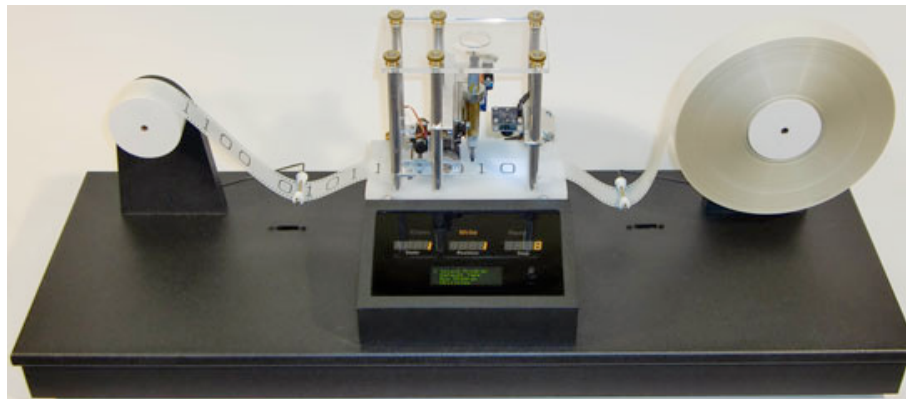
Fig. 16: Protótipo contemporâneo da Máquina de Turing
