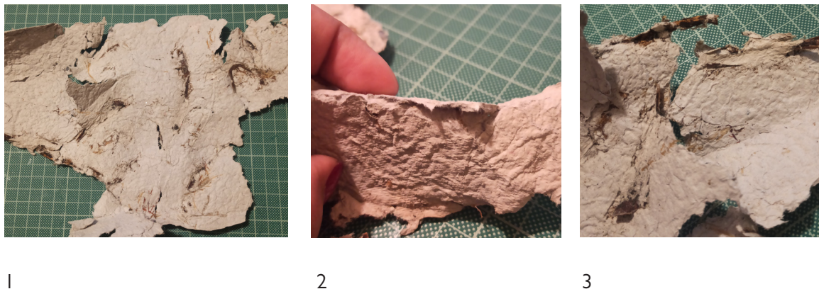
Figura 56 – Demonstração dos resultados da segunda amostra 1) material seco, 2) fratura do material após a flexão e 3) fratura do material nas áreas com sargaço. Fonte da imagem: elaborada pela autora.
