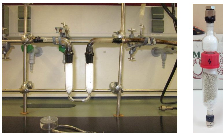
Figura 2.6 – Tubo em U e tubo de absorção de dióxido de carbono.
