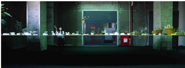
O arquitecto japonês Junya Ishigami (1974), apresenta a Magic Table uma mesa constituída por uma única peça de aço com 3mm de espessura, 10m de comprimento e 2,6m de largura. Esta peça é coberta por uma chapa de madeira com 3mm de espessura. Por cima foram colocados uma série de objectos que estão em exposição. Qual é a solução utilizada para manter esta estrutura?
