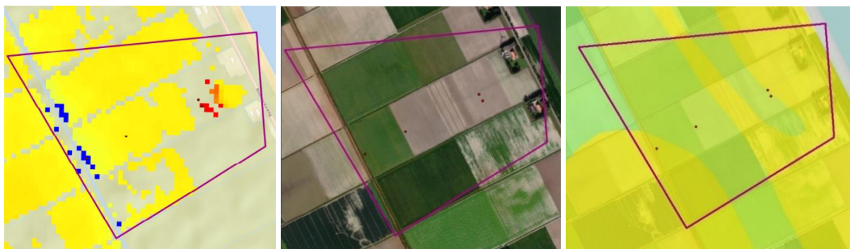
Afbeelding 2.1: Perceel in de Wieringerwerf (Noord-Holland) aan de Noorderdijkweg. Links de kaart met de organische stof berekening op basis van Sentinel-2 beelden; Midden een luchtfoto van het perceel; Rechts de bodemkaart met grondsoorten (groen = kalkrijke poldervaaggronden (lichte zavel, Mn12A) en geel = kalkhoudende vlakvaaggronden (zeer fijn zand, Zn40A)). Bron: Pdok, BRO Bodemkaart – Bodemvlakken.
