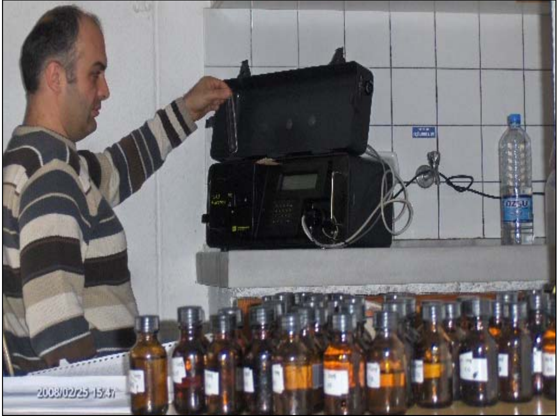
Şekil 6.7 Kuyulardan toplanan izleyici içeren suyun mor renkli şişelerden alınarak seyreltilip okunması.
